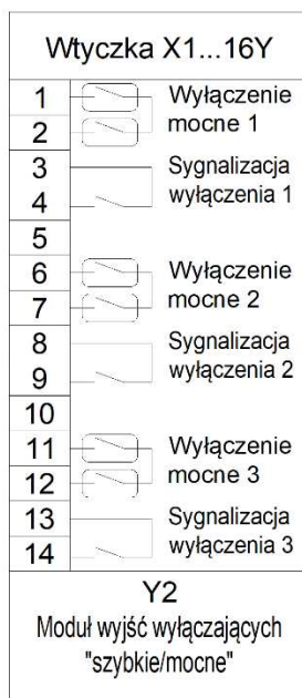
Rys. 2.6. Schemat modułu wyjść szybkiego wyłączenia o podniesionej zdolności łączeniowej
