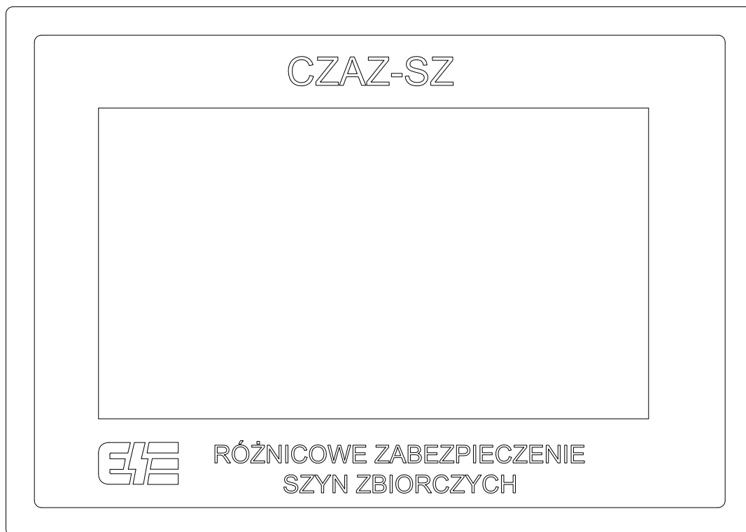
Rys. 1.2. Zabezpieczenie szyn zbiorczych CZAZ-SZ, widok z przodu panelu frontowego (Front – zatablicowy)
