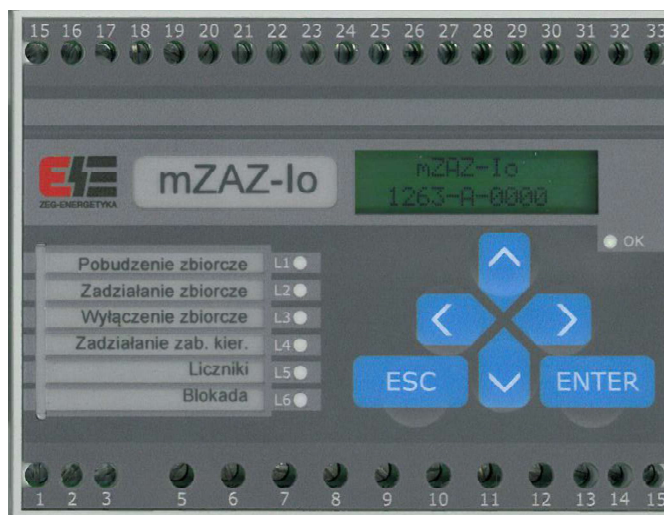
Rys. 15. Przykładowa płyta czołowa urządzeń serii mZAZ (przełącznik typu mZAZ-lo).
